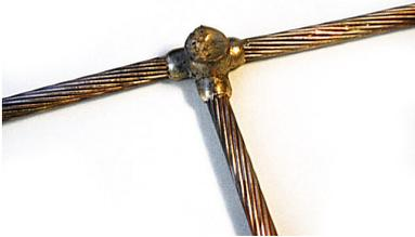
La soudure aluminothermique est un procédé totalement autonome pour réaliser des liaisons électriques de très haute qualité entre des matériaux tels que cuivre, alliages de cuivre ou acier. Ce procédé consiste en une liaison moléculaire garantissant une fiabilité et une durabilité dans le temps inégalées permettant de conserver des propriétés électriques optimales.
